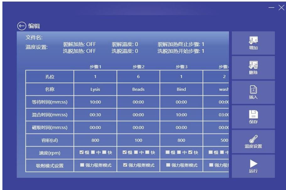
在实验程序文件设置界面，点击右侧部分“温度设置”图标进入温度设置界面，设置打开或关闭裂解加热/洗脱加热功能、裂解温度、洗脱温度，裂解加热终止步骤和洗脱加热开始步骤，设置完成后点击“确定”图标返回实验程序文件设置界面。
